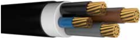
0,6/1 kV N2XY, Tek veya Çok Damarlı Enerji Kablosu, Bakır İletkenli, XLPE izoleli, PVC Kılıflı
